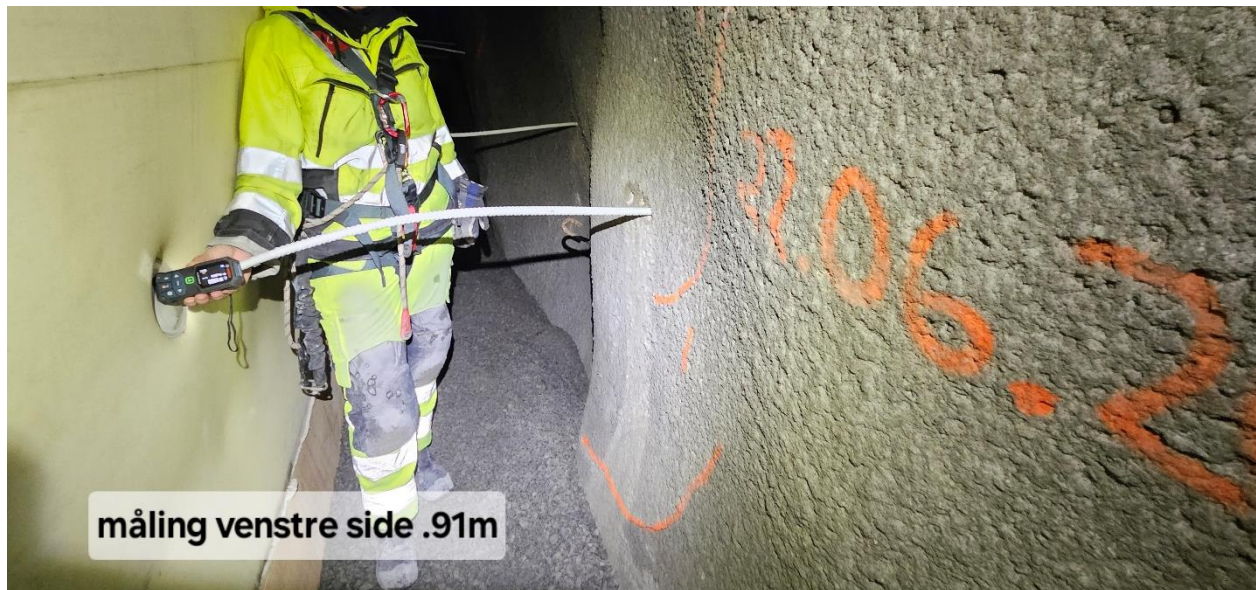
Figur 5. Måling av festebolt på venstre side. Markert med hvit spray på platen. Avstand målt til 0.91 m.
