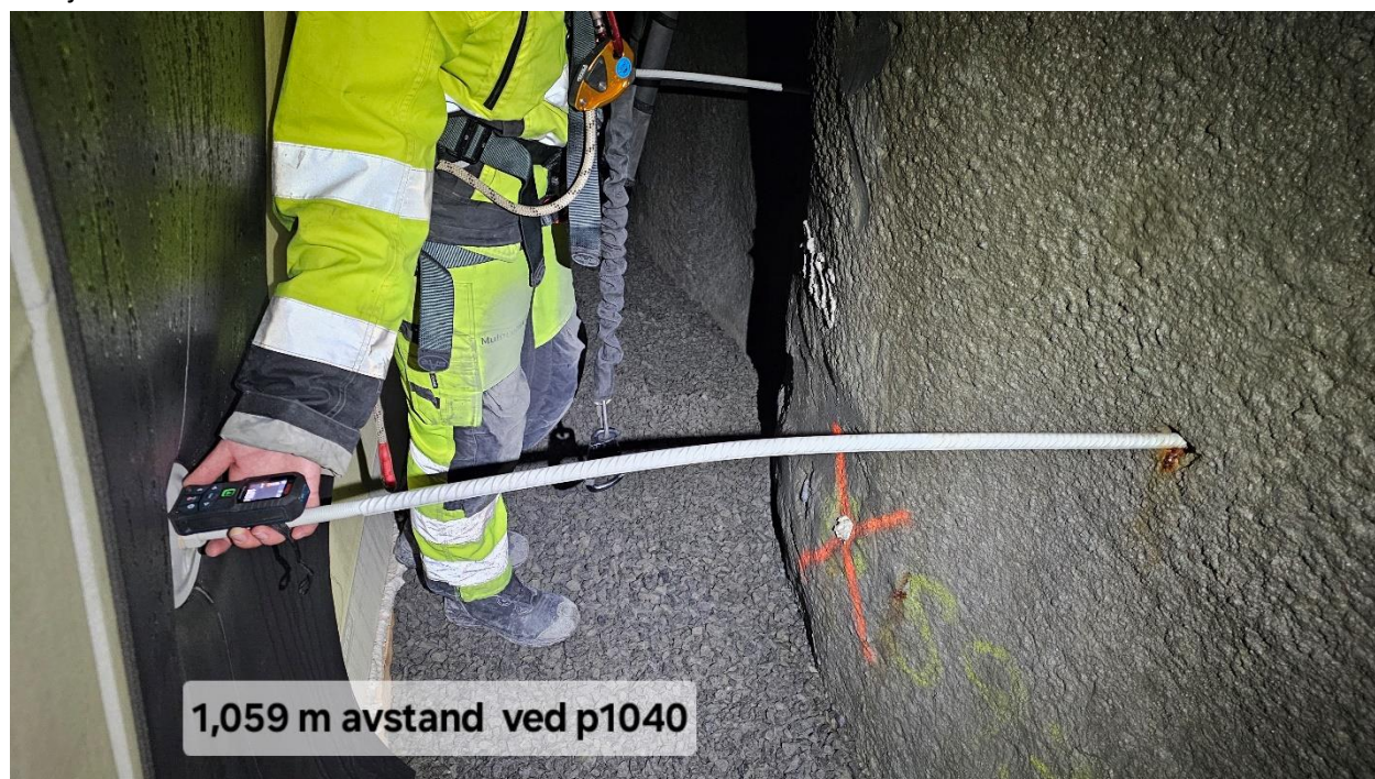
Figur 3. Målt en festebolt på høyre side. Markert med hvit spray på platen mot PE-skum. Avstand målt til 1,06 m på ca. Pel 1040.
