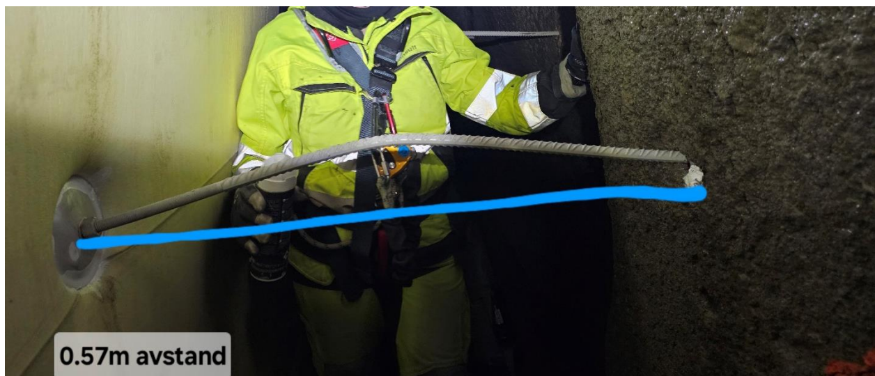
Figur 6. Måling av festebolt på venstre side. Markert med hvit spray på platen. Avstand målt til 0.57 m.
